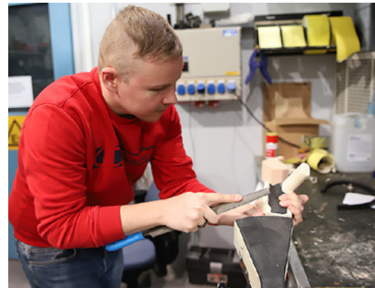
Teollinen muotoilija Henri Hokkanen viilaa muovista tehtyä kyynärnojan suunnittelumallia. Muotoilustudiossa käytetään paljon muovia, puuta ja 3D-printattuja osia, kun tulevista traktoreista tai esimerkiksi ohjaamoista tehdään näköisille.
