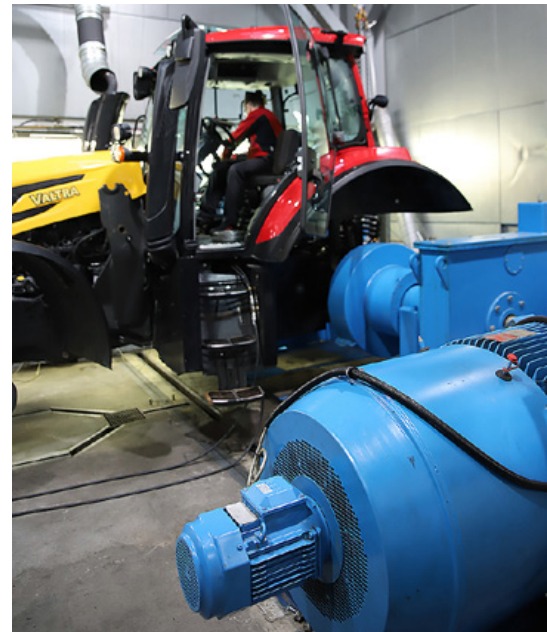
Jan-Erik Karjula ajaa traktoria testipenkissä. Testipenkissä saatujen tuloksien avulla kehitetään paitsi itse traktoria, myös siitä tehtyä simulaattoria niin, että se jatkossa vastaa entistä tarkemmin oikeaa traktoria.
