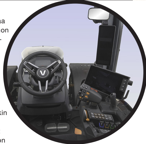
S-sarjaan on saatavana TwinTrac-taakseajolaitteisto ja lisäteho antaa täyden moottoritehon ulosotolle myös isoimmassa mallissa.
