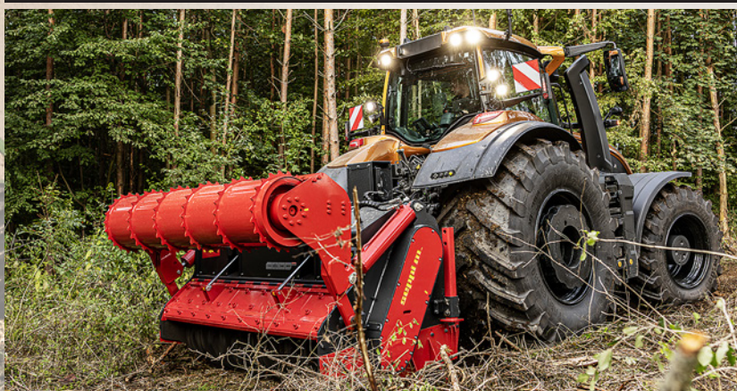
S-sarjaan on saatavana TwinTrac-taakseajolaitteisto ja lisäteho antaa täyden moottoritehon ulosotolle myös isoimmassa mallissa.
