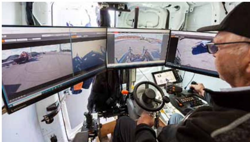
Tässä traktorin hallintalaitteet on sijoitettu pakettiautoon. Traktoria voi kauko-ohjata myös toisen traktorin hallintalaitteilla tai rajoitetummin erillisellä, kannettavalla pädin kaltaisella hallintalaitteella.
