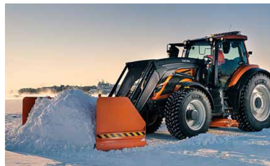
Keräävä aura ja alaterä ovat hyvä yhdistelmä taajamissa, kun pitää puhdistaa isoja pihvoja ja parkkipaikoja huolellisesti.
