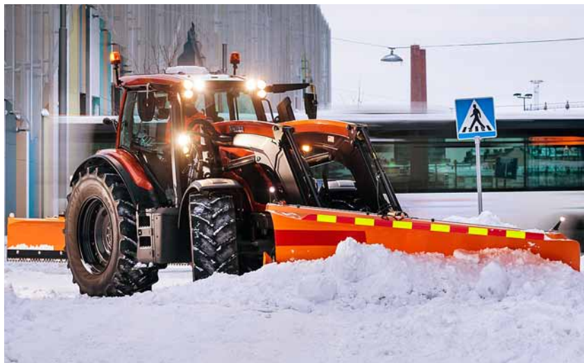
Alueaura Basicissa on matalampi siipi, joka riittää hyvin Etelä-Suomen olosuhteissa. Lumistoppari pitää liittymät puhtaina. Raspi poistaa polanteen ja karhentaa pinnan.
