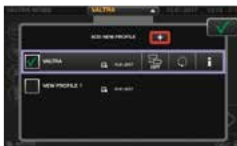
Sisältää profiilit kuljettajille ja työkoneille, joita on helppo muuttaa mistä tahansa näytön valikosta. Kaikki asetusmuutokset tallennetaan valittuun profiiliin.
