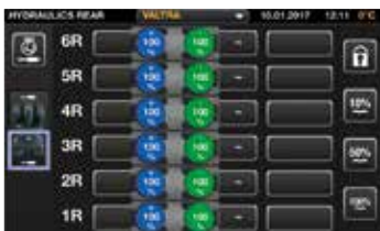
Voit nimetä minkä tahansa ohjaimen käyttämään mitä tahansa hydraulitoimintoa, mukaan lukien etu- ja takahydrauliiventtiileitä, etu- ja takanostolaitetta ja etukuormainta.
