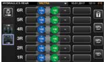
Voit nimetä minkä tahansa ohjaimen käyttämään mitä tahansa hydraulitoimintoa, mukaan lukien etu- ja takahydrauliventtiileitä, etu- ja takanostolaitetta ja etukuormainta.
