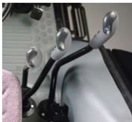
Vaihtevalitsimet oikealta: suunnanvaihto, nelinopeuksinen päävaihtevalitsin, aluevaihte.
