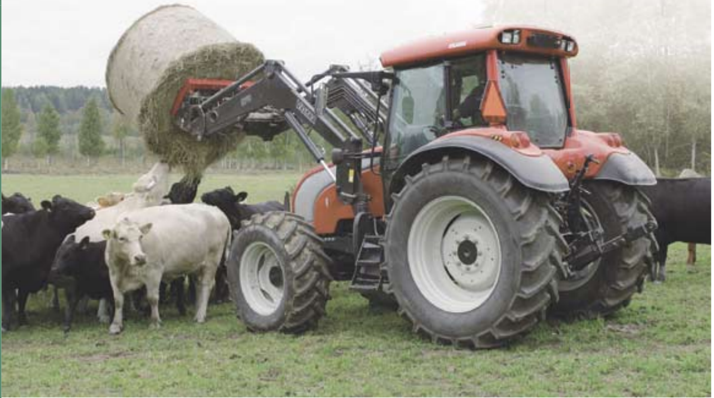
Uuden C-sarjan painojakauma on 39/61, mikä on ihanteellinen etukuormaintyössä.
