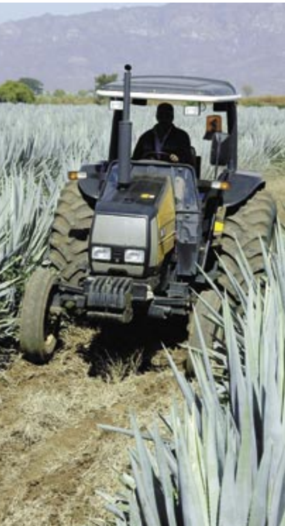
Sausan tequilafarmin sata traktoria ovat 50–80 hevosvoimaisia takavetoisia. Näppärä, luotettava ja melko voimakas kone on mieluista agaverivien väleissä. Valtran 700-mallia on Sausan tilalla peräti 40 kappaletta.
