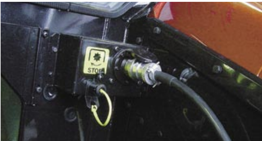
ISOBUS-työkone on yhdistetty traktoriin yhdellä kaapelilla.
