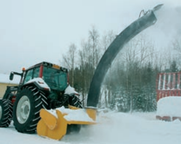
Jani Maihkila esittelee Roten lumilinkoa. Pitkä purkuputki on erikoisvaruste Kemin lumilinnatyömaata varten.
