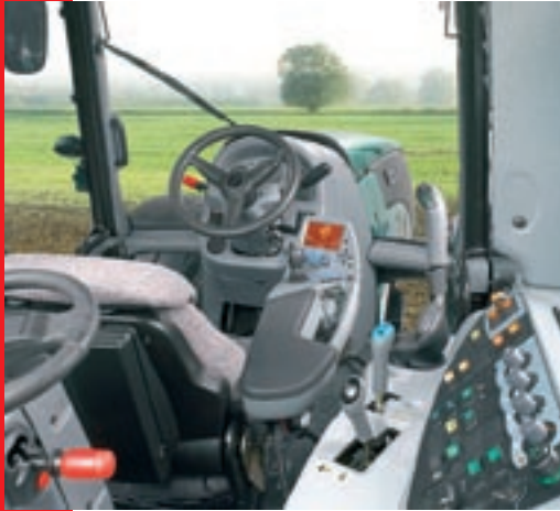
T-sarjan ohjaamo on tilava, ergonominen ja turvallinen. TwinTrac-taakseajolaite (lisävaruste) antaa hyvät edellytykset taaksepäin työskentelyyn ja kuljettajan viireyskin säilyy paremmin koko työpäivän ajan. Kuva Advance-ohjaamosta.
