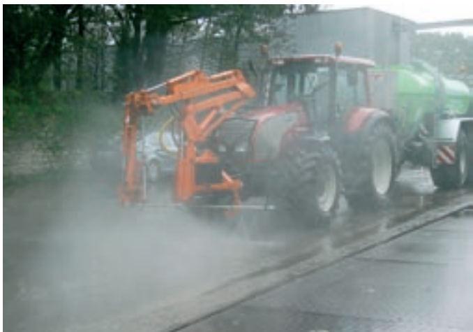
Ylempi kuva. Kuuma vesi ja riittävä paine poistavat katolta helposti sammalen, muut kasvit ja lian.
