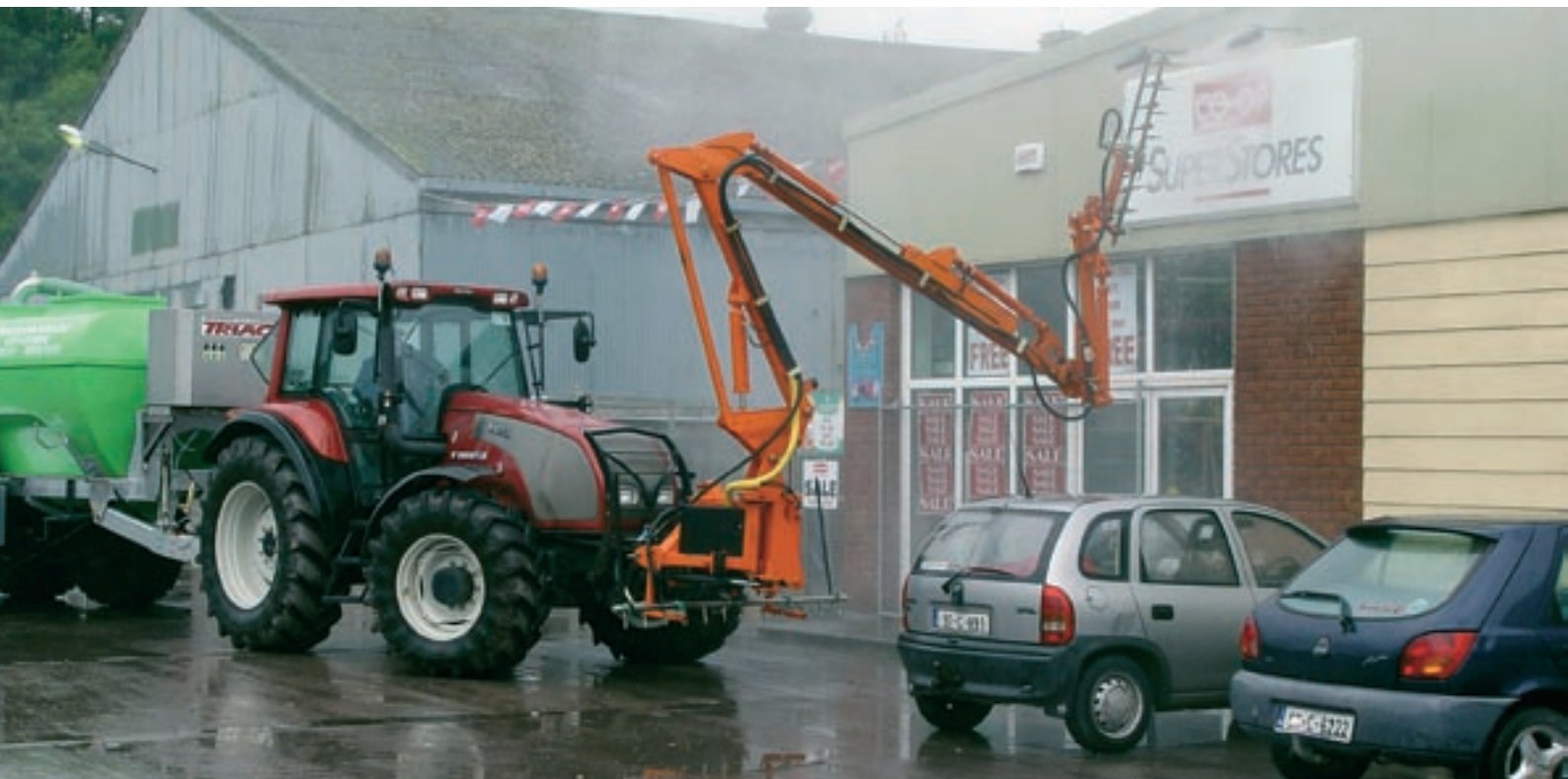
Puomin voi helposti nostaa tielle pysäköityjen autojen tai muiden esteiden yläpuolelle.
