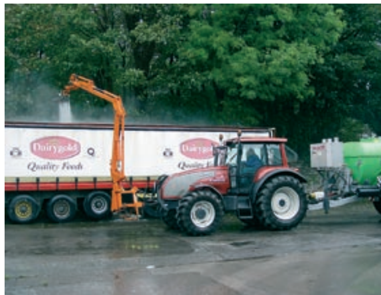
Pesuyksikkö pystyy helposti seuraamaan pysäköidyn auton reunoja.
