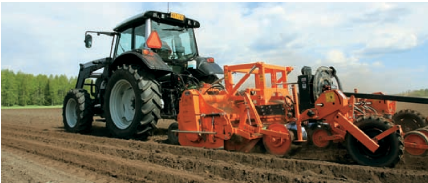
N121 Advancen perässä oleva uusi hollantilainen kylvökone sekä jyrssi penkit että kylvää yhdellä vedolla.
