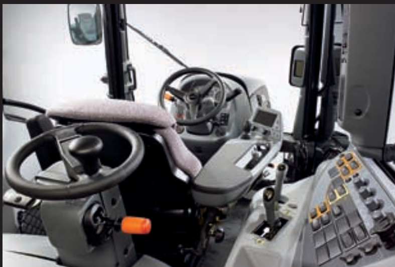
Sisältä Versu- ja Direct-tractorit ovat erittäin avaria, eikä vaihdevipuja ole enää lainkaan. Taka-sivuikkunan voi avata.
