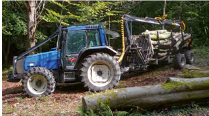
Käytetty Valtra 6650 oli varhainen tulokas, ja sitä käytetään pääasiassa puiden hoitoon ja saha- tai polttopuiksi kaadetun puutavaran kuljettamiseen.
