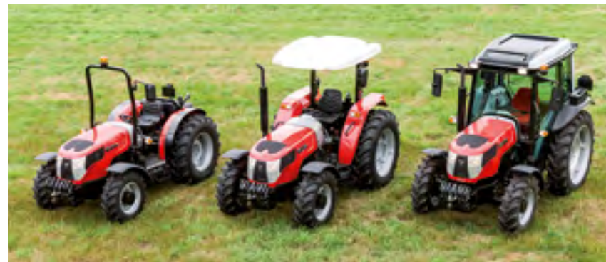
Pieniä A-sarjan traktoreita on saatavana leveämmällä tai kapeammalla raidevälillä sekä avo-ohjaamolla, aurinkolipalla tai ohjaamolla varustettuna.
