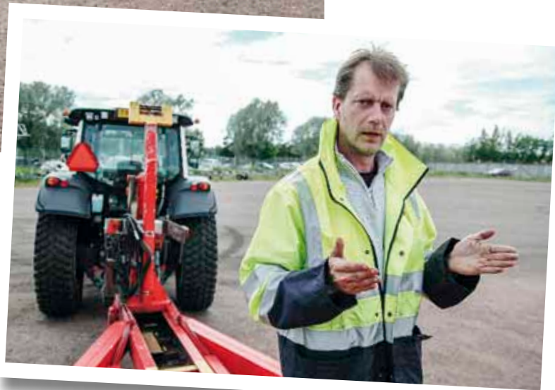
Kotkan Moottoriveneseuran traktorinkuljettaja Ari Jaakkola esittelee hydraulitoiminnoilla varustetun venetrailerin toimintaperiaatetta. Veneen köli lepää liukuvalla tasol-la ja neljä pehmustettua tassua puristavat veneen kylkiä.
