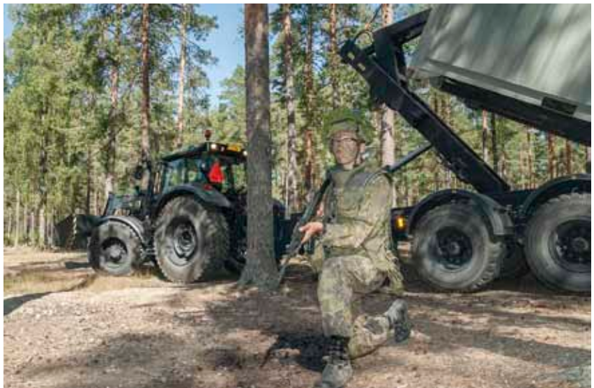
Traktorit ovat osoittaneet monipuolisuutensa Puolustusvoimien tehtävissä. Niillä voi lastata ja purkaa kuormia metsämaastossa sekä vetää jopa 16 tonnain painoisia kontteja ja käsitellä niitä koukkulavakärryllä. Lisäksi traktorit auraavat tiet paitsi itselleen, myös muille ajoneuvoille.
