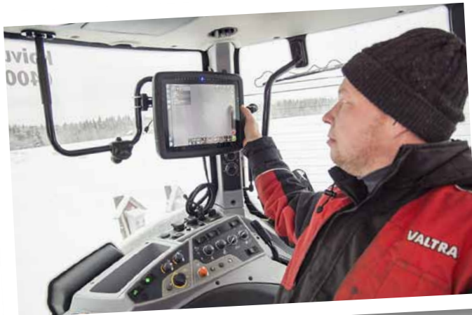
Tero Koivuranta viljelee perunaa Karijoella. T214 Directin automaattiohjaus on apuna penkkijyrsimen käytössä, sadonkorjuussa, kynnössä ja lähes kaikissa muissakin töissä. Automaattiohjaus kuljettaa traktoria parin sentin tarkkuudella.
