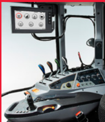
Vasemmalla: Nyt myös N- ja T-sarjojen HiTech- ja Active -malleihin saa vastaavan näytön kuin SmartTouch-malleihin. Näytön avulla saa käyttöön täsmäviljelyominaisuuksia, kuten AutoGuide-automaattiohjauksen.
