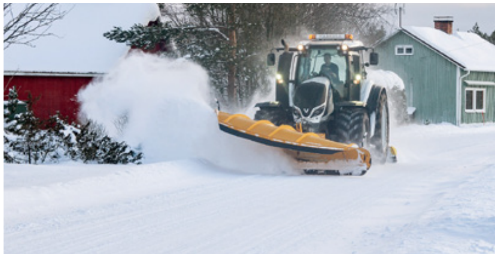
T234 Versu auraa kylätietä Vuometin auralla, polanne poistuu perässä olevalla tappiterällä. Traktori on Suomi 100 -juhlavuoden mallia, numeroltaan 16. Lohtajalla mereltä puhaltava tuuli pölyyttää lumen helposti takaisin tielle.
