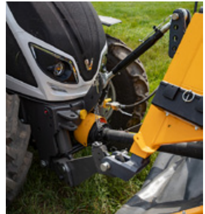
Uusi A-sarja voidaan varustella Unlimited-studiossa myös etunostolaitteella tai etuvoimanotolla.
