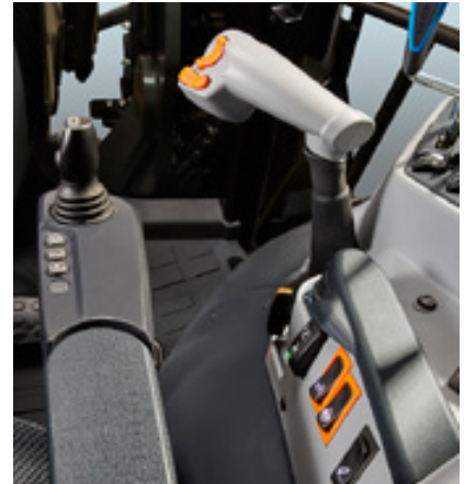
Vaihteiston käyttö on helppoa ergonomisella kahvalla ja sen keinukytkimillä.
