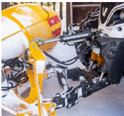
Haasala Oy valmistaa nelossarjan Valtroihin auraustukia etunostolaitteen varsien väliin. Tuki estää varsia vääntymästä, jos auralla törmää kaivonkanteen tai muuhun esteeseen. Tukia myydään AGCO Suomen kautta.
