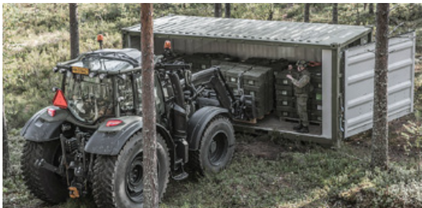
Suomen puolustusvoimissa huolto viedään joukoille maastoon traktoreiden vetämissä konteissa. Traktorit myös tarvittaessa kunnostavat teitä, auraavat lunta ja lastaavat tai purkavat kuormia sekä osallistuvat linnoittamiseen.
