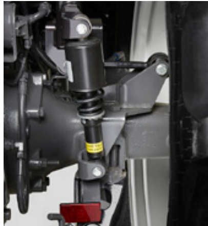
Mekaaninen ohjaamajousitus on säädettävä ja vakautettu kahdella Panhard-tangolla.
