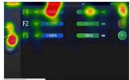
Testaajien silmänliikkeitä tutkittiin skannerilla, kun nämä käyttivät SmartTouchia. Silmänliikeskanneri paljasti esimerkiksi sen löysivätkö käyttäjät haluamansa toiminnon ja ymmärsivätkö he kuvakkeen.
