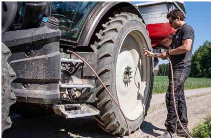
Uuteen G-sarjaan on mahdollista saada paineilimaliitin traktorin sivulle, ohjaamon rappusten kohdalle. Esimerkiksi renkaiden ilmanpaineiden säätö on helppoa.
