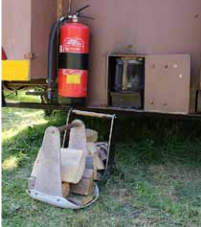
Kiuas sytytetään ulkoa vaunun takaa. Polttopuut kulkevat takana olevissa laatikoissa.
