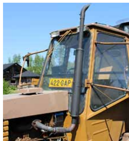
Valmet 602:ssa on kahden henkilön penkki ja pilaripakoputki.
