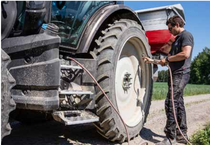
Till den nya G-serien fås en tryckluftskoppling på traktorns sida, vid hyttens trappa. Till exempel justeringen av däckens lufttryck är enkelt.
