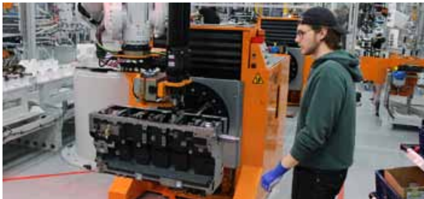
Asentaja Julius Salmela asentaa kuusisylinteriseen moottoriin kampiakselia yhteistyössä teollisuusrobotin kanssa.
